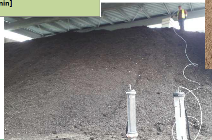
Rilievo delle emissioni dallo stoccaggio del compost
