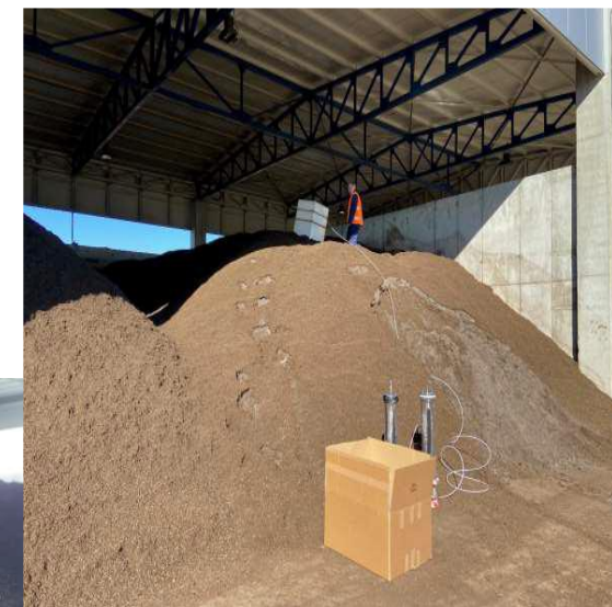
Rilievo delle emissioni dallo stoccaggio del compost
