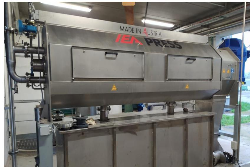
*Pressa a vite (separazione S/L)*
