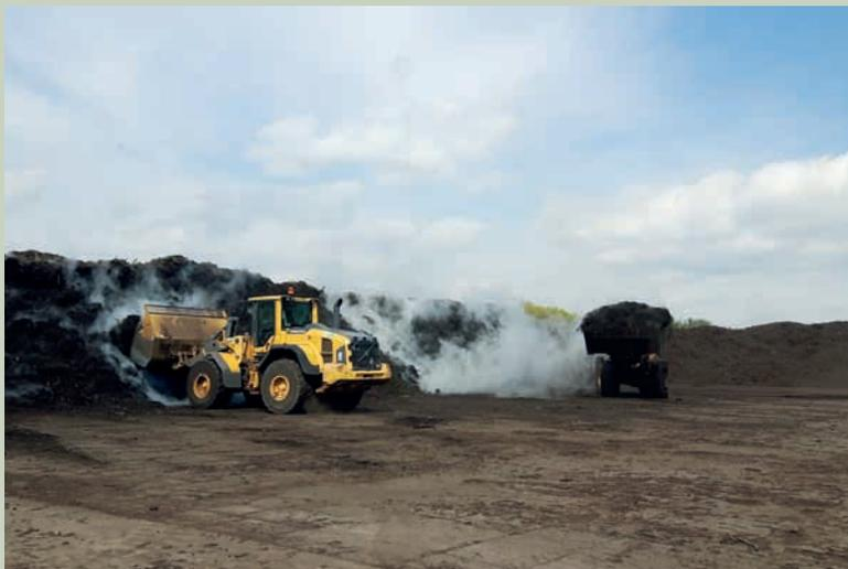
**Nel corso di un processo di compostaggio si sviluppano importanti quantità di calore, evidenti attraverso l'evaporazione dell'acqua presente nelle miscele.**
